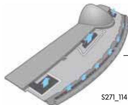
Defrostdüsen und Ausströmer für die indirekte Belüftung in der Schalttafel
