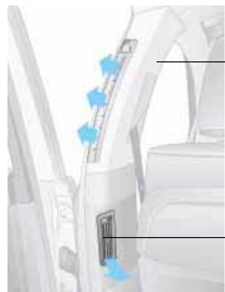
Defrostdüsen und Ausströmer für die indirekte Belüftung in der Schalttafel
